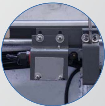
床盖板打开监测装置
